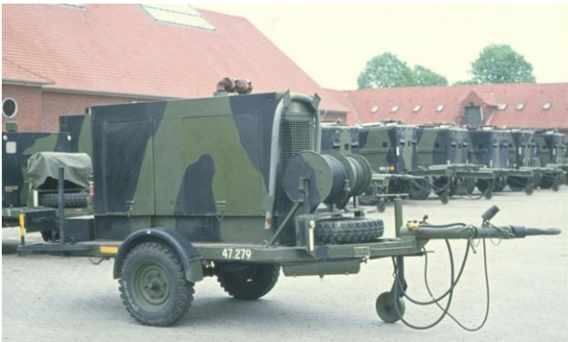
Fig.- 18 – Hercules 18.8 kW generator
